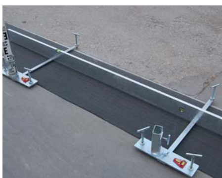
7. A nivelláló készletre helyezett libellás lehúzóléc
