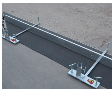
7. A nivelláló készletre helyezett libellás lehúzóléc
