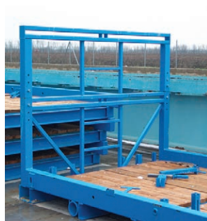
19. Szállítókeret – alacsony homlokfal magassítással
