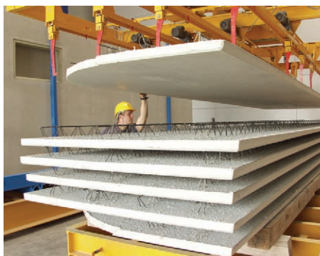
3. Leier mesterpanel (LMP) mozgatása a gyártás során
